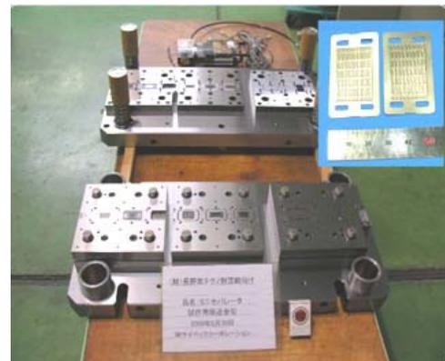
図 ミニチュアセパレータ
