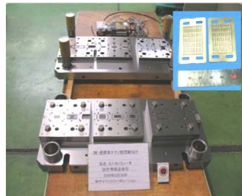
図 ミニチュアセパレータと成形に利用した順送金型
