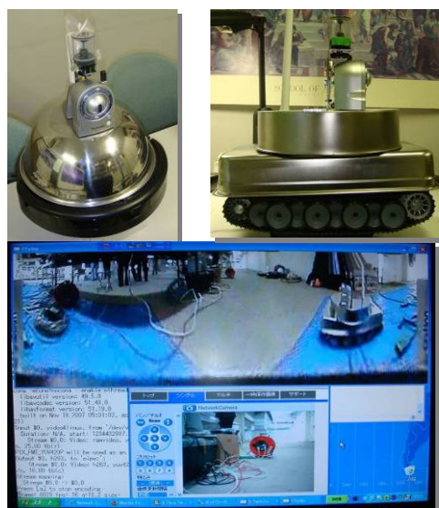
図5 遠隔制御ロボット（上：ロボット概観 下：遠隔制御画面）
