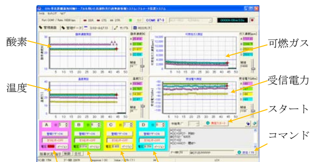
図 3 テレメータ装置概要 (上：端末 下：管理画面)
