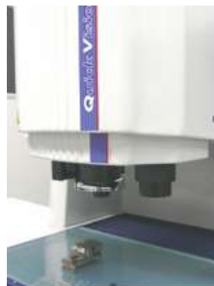
図2 測定ヘッド(中央:画像、右:レーザ)
