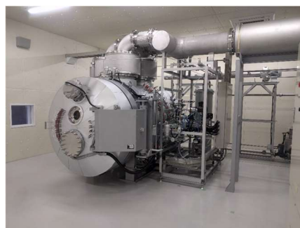
図3 防爆試験機 (公財)南信州・飯田産業センターで整備
