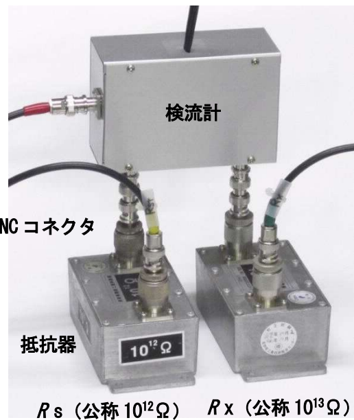
図5 検流計と抵抗器の接続例
