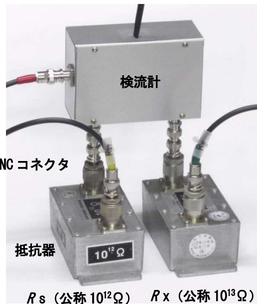
図5 検流計と抵抗器の接続例
