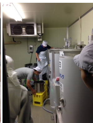
仕込作業の様子 (温調仕込タンク)
