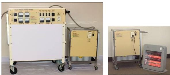
充電時(左:親機、右:子機) 使用時(子機) 図 2 試作した充電システム (親機、子機)
