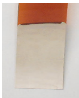
図2 樹脂板上への無電解ニッケルーリンめっき例
