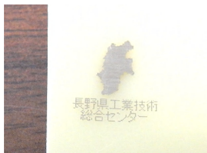
図3 インクジェット法による樹脂上への部分めっき例
