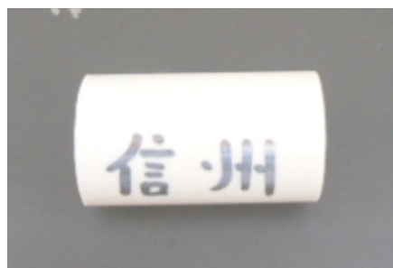
図4 立体形状物への部分めっき例
