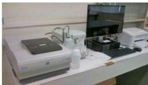
図 2 ゼータ電位・粒径測定装置外観
