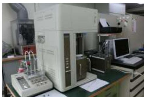
図 1 比表面積・細孔径分布測定装置外観
