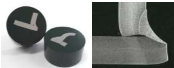
図2 検査用鏡面試料と組織観察の例
