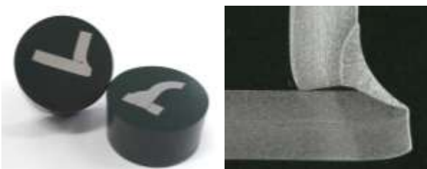
図2 検査用鏡面試料と組織観察の例
