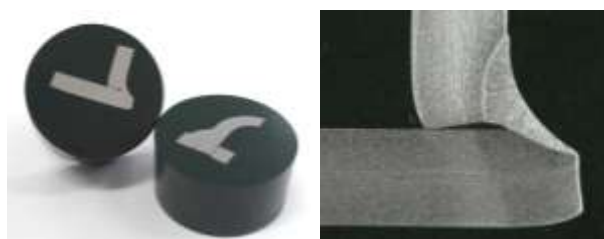
図2 検査用鏡面試料と組織観察の例
