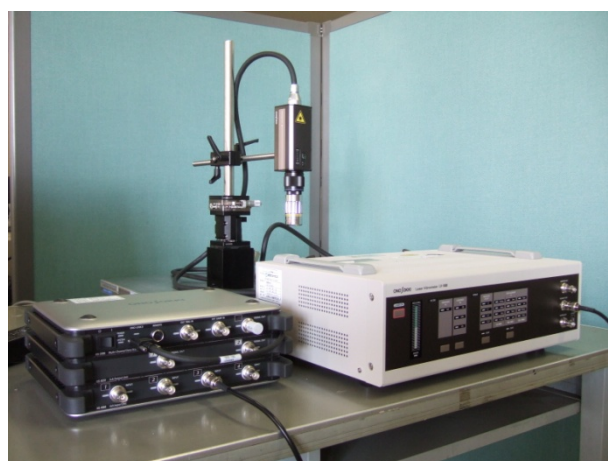
図2 装置概観(レーザドップラー振動計)
