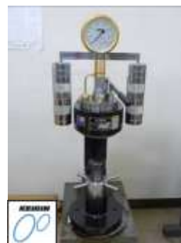
図3 ブリネル硬さ試験部
