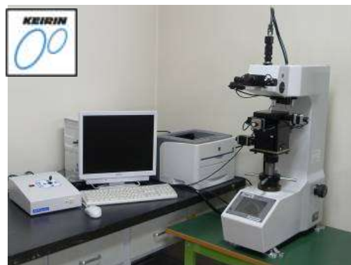
図1 ビッカース硬さ試験部
