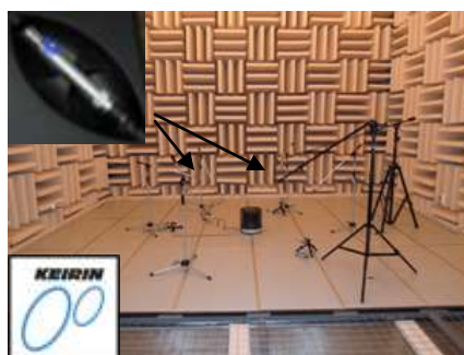
図1 音響パワー測定用マイクと半無響室
