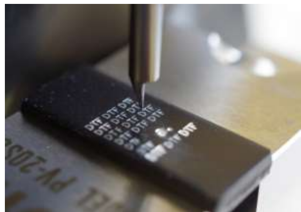
図2 加工した文字（文字高さ 2mm）
