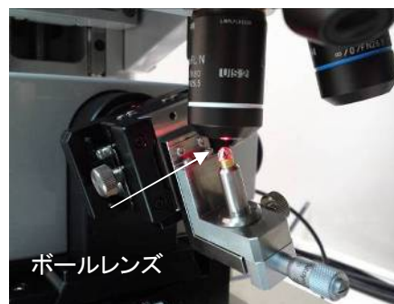
図2 回転ステージを用いたボールレンズ形状測定例
