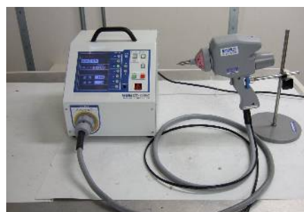
静電気許容度試験機
