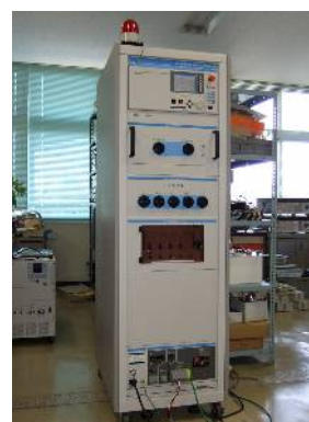
雷サージ許容度試験機
