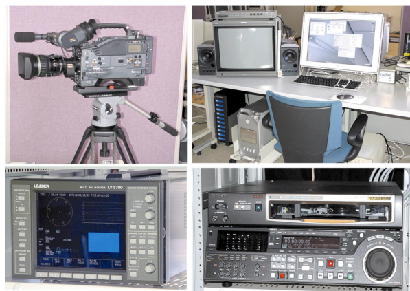
図1 高精細デジタルビデオカメラ (左上)、高精細映像編集装置 (右上)、高精細波形モニタ (左下)、高精細デジタルビデオレコーダ (右下)
