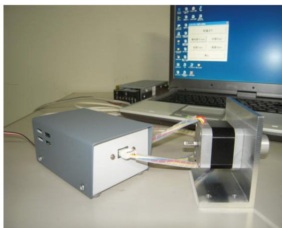
図 1 多摩川精機製モータ（右）と開発した駆動技術（制御ソフトウェア）を搭載したドライブ装置（左）
