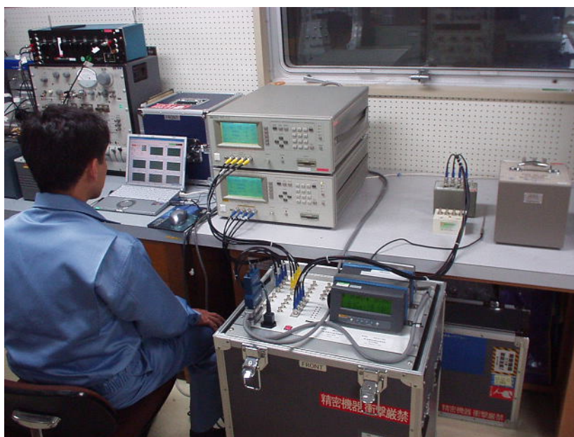
図1 開発した遠隔校正システム（中央下） （左上：制御用パソコン、中央上：インピーダンス測定器、右上：標準器）
